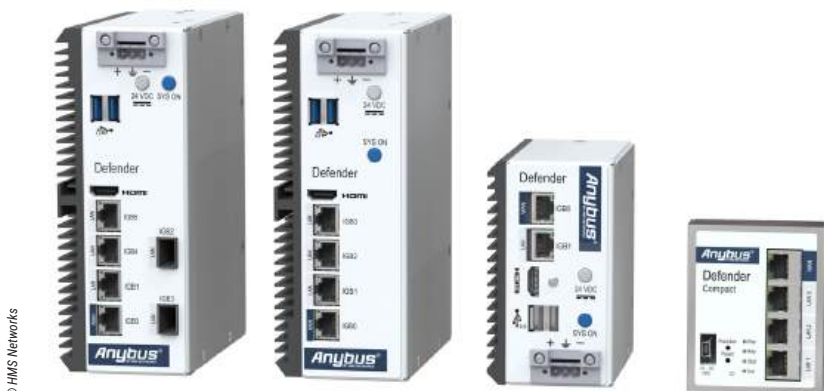
Les pare-feu Anybus Defender de HMS Networks intègrent la fonctionnalité DPI qui analyse les protocoles industriels et qui permet, par exemple, d'empêcher des requêtes d'écriture vers un automate programmable tout en autorisant la lecture des données.
