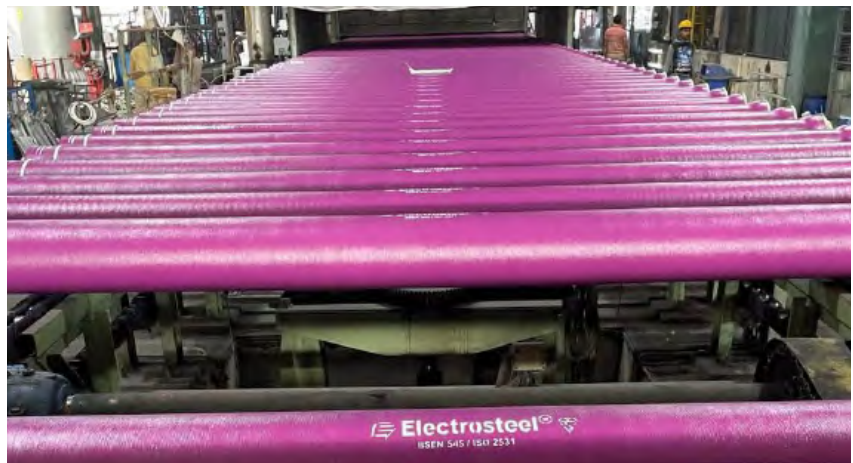
Ce tuyau en fonte ductile d'Electrosteel est doté d'un revêtement en polyuréthane intérieur haute performance pour les réseaux d'eaux usées.
