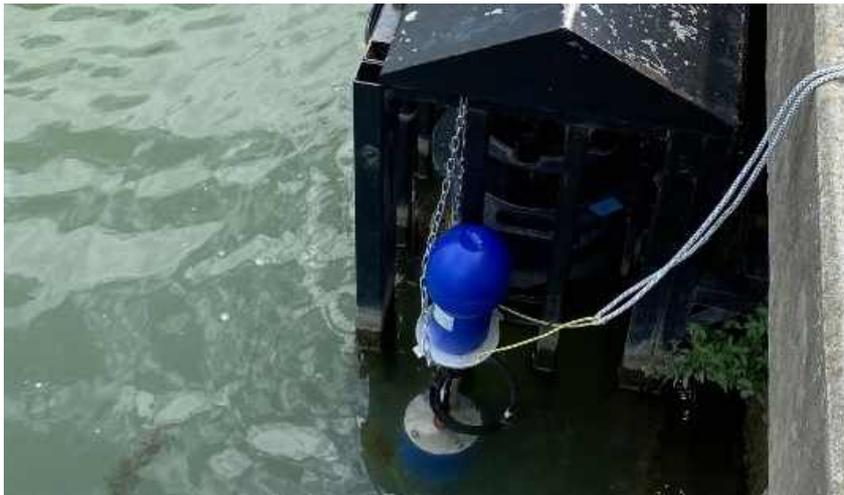
Sonde nke Bactrack déployée à la Villette, à côté des analyseurs Fluidion Alert System V2 (à l'intérieur de la cage de protection), pour une mesure in situ de la qualité des eaux de baignade.
