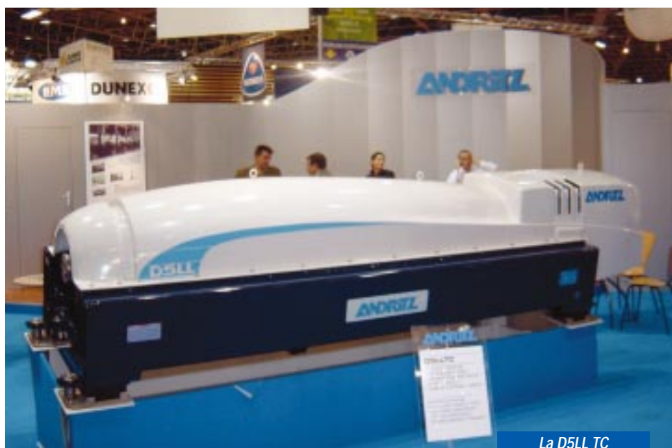
La D5LL TC est la première décanteuse centrifuge à transmission co-axiale.
