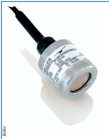
Transmetteur de niveau série 46X, à technologie capacitive. Ce transmetteur, de plus grand diamètre, est adapté pour la mesure de très faibles niveaux (jusqu'à 30 cm de pleine échelle avec une précision de +/- 0.5 mm)
