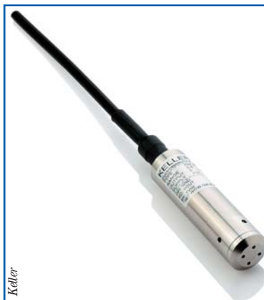
Transmetteur de niveau série 36X destiné aux applications qui requièrent une grande précision. Cette sonde intègre un microcontrôleur 16 bits pour la compensation du signal. Précision typique (linéarité) de 0.025% de l'étendue de mesure.
