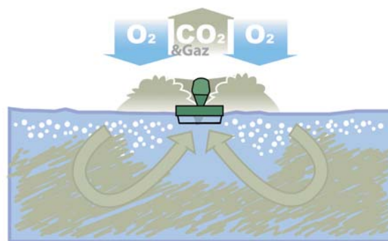
Schéma de principe de l'aérateur Flopulse
