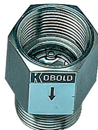
Selon la pression différentielle concernée, l'ouverture de l'interstice entre les plaques à ressort et le plan de joint varie de manière continue. Une diminution de pression différentielle entraîne un élargissement de l'ouverture, une augmentation de pression une réduction de cette même ouverture, ce qui permet de cette manière de stabiliser la quantité de liquide s'écoulant.
