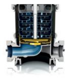
tec sans exiger de modifications du corps de pompe extérieur. Elle affiche un diamètre d'aspiration modifié, des aubes permettant un écoulement légèrement diagonal ainsi qu'un corps d'étage de conception nouvelle, ces caractéristiques permettant d'améliorer sensiblement la courbe NPSH de la pompe.
