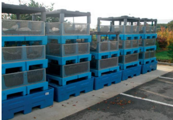
Des casiers de déshydratation d'une contenance de 250 litres gerbables sur 2 à 6 niveaux permettent d'accueillir les sacs d'Osmofilm® contenant les effluents à traiter. Ceux-ci sont stockés sur une zone de rétention pouvant contenir la totalité des effluents contenus dans les casiers remplis.
