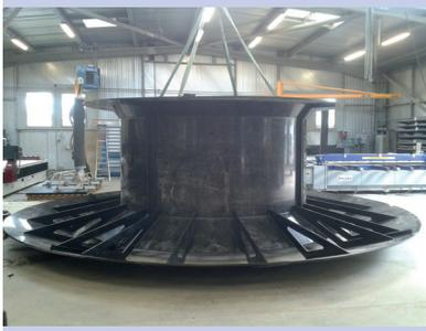
Dans un clarificateur traditionnel, les arrivées d'eaux usées provenant des bassins d'aération sont rabattues vers le bas par une jupe de dissipation d'énergie, ce qui engendre des tourbillons au point de recirculation des boues car des courants centrifuges provoquent l'étalement et la dispersion des boues.
