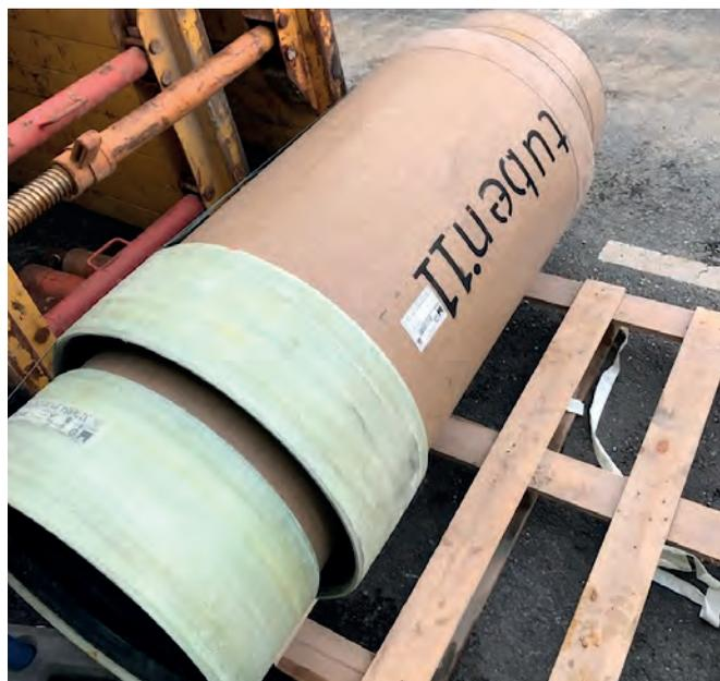
La Direction de l'Eau de Bordeaux Métropole a choisi des tubes en PRV double peau sur certains tronçons sensibles et des tubes en PRV étanche sur le reste du tracé.
