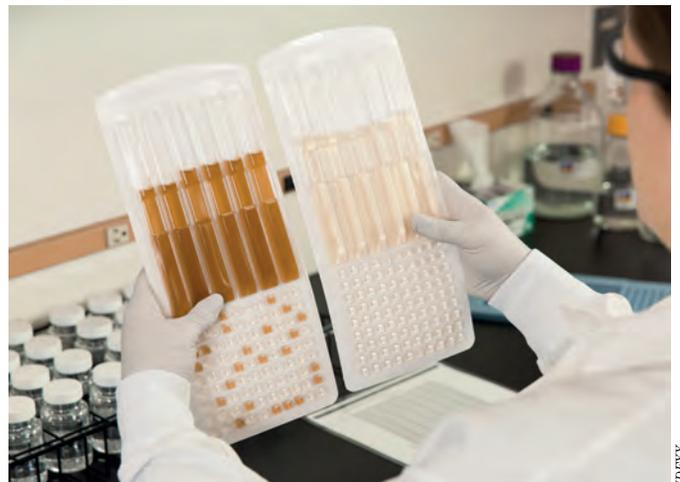
Legiolert réduit les temps de réaction des services sanitaires grâce à une quantification spécifique et précise de *L. pneumophila* dans l'eau, avec des résultats confirmés.
