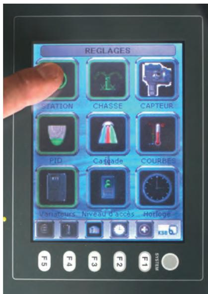
À Grenoble, chacune des 7 stations équipées dans le cadre du diagnostic est dotée en surface d'un "coffret intelligent" comprenant un variateur de fréquence par pompe, un écran tactile intuitif pour piloter l'installation, la gestion automatique par un programme expert KSB et enfin un coffret double porte largement dimensionné.
