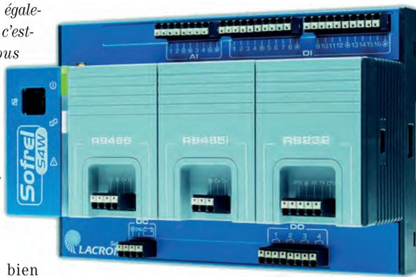
**S4W reste simple à utiliser. Le design et la configuration 100 % logicielle facilitent et sécurisent la prise en main du produit. Les borniers, débroschables, sont de type "push-in" pour être manœuvrés d'une seule main. La carte Sim est directement accessible sur le côté, sans qu'il soit nécessaire d'ouvrir le boîtier ni de manipuler une carte électronique.**
