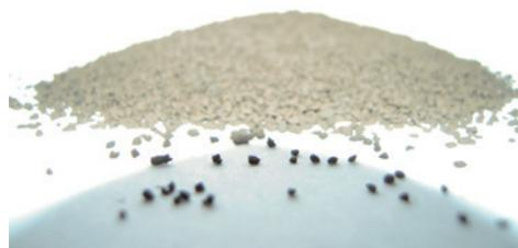
minéral naturel concassé sans additif, qui permet de les réduire en dessous du niveau guide maximum de 0,05 mg/l pour le fer et 0,02 mg/l pour le manganèse.
