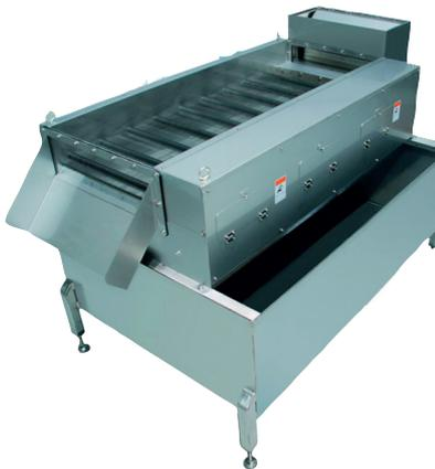
La rotation en continu de cylindres de forme ovale permet d'augmenter substantiellement la capacité de traitement et de déshydratation.
