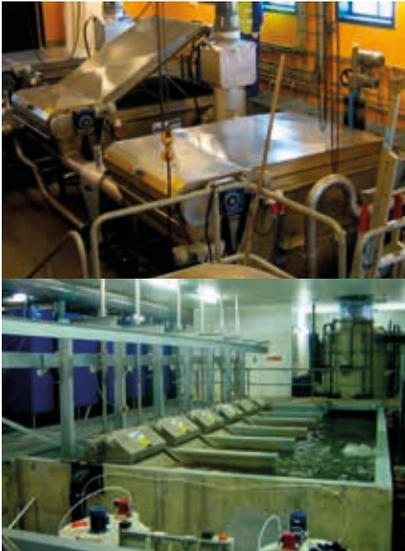
**Primegreen™** est un système degremon<sup>®</sup> de filtration primaire basé sur une technologie de filtration mécanique en continu sur bande. Il est installé en aval d'un dessableur, en lieu et place d'un décanteur primaire, pour atteindre un objectif de qualité d'eau soit pour un rejet dans le milieu naturel, soit pour réduire la taille du traitement biologique. Il permet d'atteindre en sortie une siccité de 20 à 30 % et ne nécessite pas d'ajout de réactifs.
