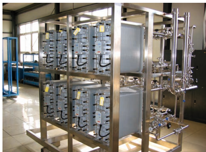
Les systèmes CDI-LX™ de Ionpure® sont conçus pour satisfaire les débits faibles et moyens exigés dans certains secteurs comme par exemple la micro-électronique, l'énergie et l'industrie pharmaceutique.
