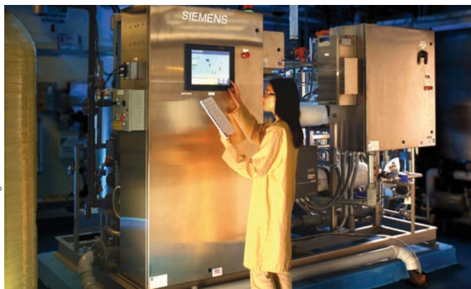
Les systèmes PreVUE™ sont préfabriqués, pré-assemblés et testés en usine afin de réduire les délais d'installation et de mise en service. Grâce à des dispositifs de raccordement rapides et des commandes facilement configurables, l'unité est rapidement prête à fonctionner.
