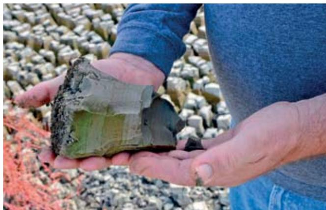
Les boues d'eau potable sont le résultat de la concentration des MES, colloïdes et précipités contenus dans les purges et vidanges des décanteurs ou flottateurs, ainsi que dans les eaux de lavage des filtres. Ces boues, généralement de nature hydrophile, renferment une quantité variable de particules selon la qualité de l'eau brute.
